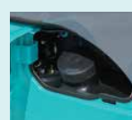
Réservoir à carburant
