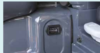
Horamètre visible depuis l'extérieur
