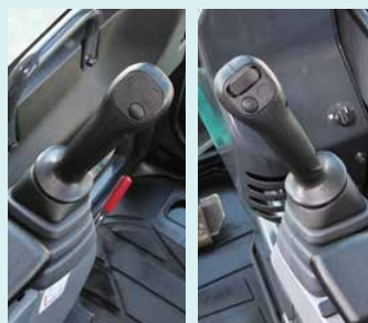
Commande proportionnelle au manipulateur (option)
