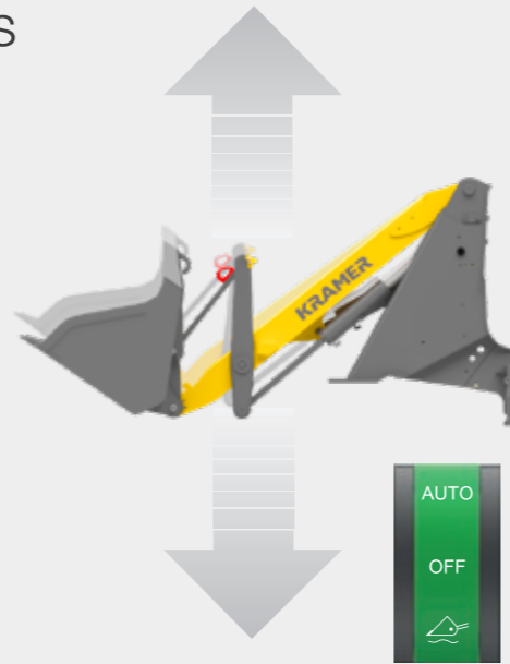
Le stabilisateur de charge automatique empêche la machine d'osciller et réduit la perte de matériau.
