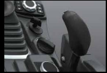
Commande de la 2 ème articulation Commande dédiée à la deuxième articulation de l'équipement grande hauteur à 4 éléments.
