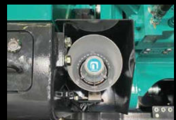
Mégaphone extérieur Le chauffeur peut alerter ses collègues au sol sans quitter les commandes de la machine.
