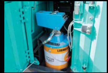
Pompe de graissage électrique Graissage rapide et facile des axes.
