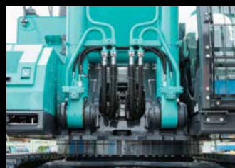
Clapets de sécurité Les vérins de pied de flèche et de l'équipement court sont équipés de clapets de sécurité pour manutentionner sans risque.
