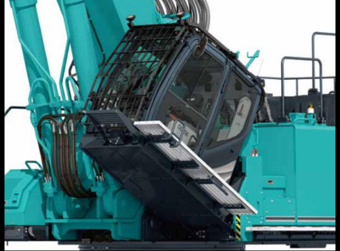
La cabine est inclinable jusqu'à 30°
