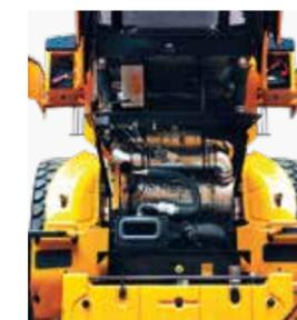
Le **capot moteur basculant est complètement escamotable** et peut être **ouvert électriquement** pour faciliter l'accès au compartiment moteur et au compartiment de refroidissement étanches. Le compartiment moteur est conçu pour éviter toute possibilité d'incendie causé par l'entrée de corps étrangers.
