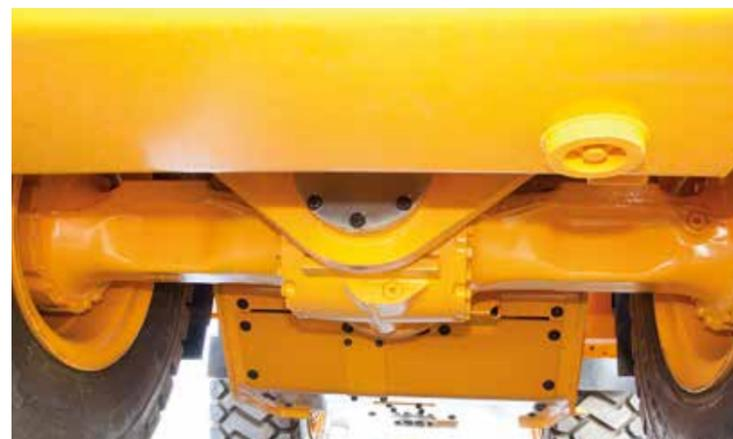
Les **essieux** de la HL960AHD sont conçus pour une fiabilité sans compromis lors des travaux intensifs continus. Malgré sa grande stabilité et sa grande capacité de transmission de puissance, l'essieu de la chargeuse sur pneus a un design compact et un faible poids. L'utilisation de freins à disques à bain d'huile réduit les pertes de freinage et améliore ainsi l'efficacité.
