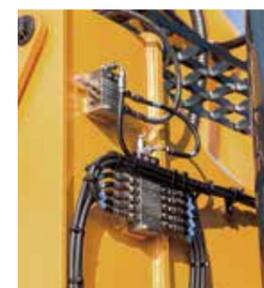
Avec le **système d'auto-graisage** en option, de la graisse est appliquée automatiquement sur les points de lubrification en fonction des besoins. Le dosage correct est assuré et le lubrifiant est appliqué uniformément, ce qui réduit la consommation de graisse et évite le gaspillage.
