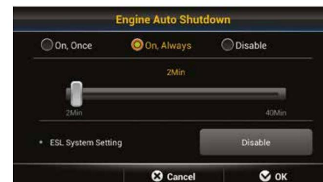
Le **moteur s'arrête automatiquement lorsque la machine est au repos** afin de réduire la consommation de carburant et d'éviter les émissions inutiles. Différents modes de fonctionnement et différentes durées de ralenti peuvent être sélectionnés selon l'environnement de travail, pour améliorer davantage l'efficacité.
