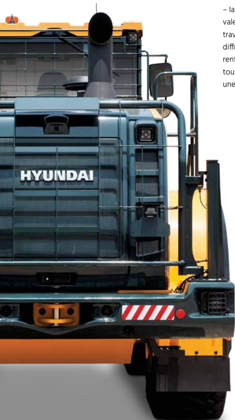
Une **grille de protection à l'arrière** protège la caméra de recul, les feux de travail, l'éclairage de la plaque d'immatriculation et le radiateur des chutes de débris. La conception ne gêne pas la vue du conducteur. La protection en acier est montée sur des charnières et s'ouvre pour accéder facilement au radiateur, pour le nettoyage ou l'entretien quotidien.
