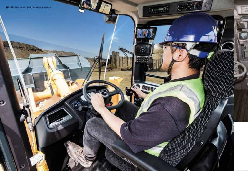
La HL980A est dotée d'un large siège confortable à suspension pneumatique avec chauffage de série. Le siège et l'accoudoir sont entièrement réglables.
