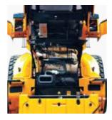
Le capot moteur est entièrement rétractable et peut être ouvert électriquement pour faciliter l'accès au compartiment moteur étanche et à la chambre de refroidissement. Le compartiment moteur est conçu de sorte à éviter tout risque de feu causé par l'entrée de corps étrangers.
