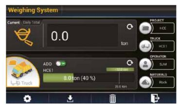
Le système de pesage cumulatif automatique/manuel de haute précision vous aide à gérer la production plus efficacement dans n'importe quel environnement. Pour une précision optimale, des icônes d'erreur de pesage et un indicateur de valeur de poids bicolore s'affichent à l'écran.
