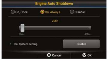
Le moteur se coupe automatiquement lorsque la machine est à l'arrêt, pour réduire la consommation de carburant et éviter les émissions inutiles. Il est possible de sélectionner différents modes de fonctionnement et temps de ralenti selon l'environnement de travail, ce qui améliore encore l'efficacité de la machine.
