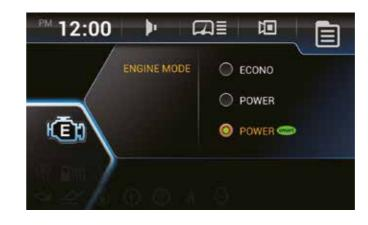
Le nouveau **mode Smart Power** règle le régime moteur lors de travaux lourds tel que le creusage pour permettre d'économiser du carburant sans compromettre les performances. La technologie permet aussi d'obtenir un bon équilibre entre force de traction et force d'arrachement.
