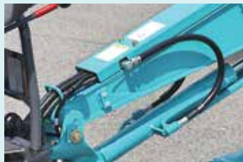
Un capot métallique protège les flexibles sur le dos de flèche
