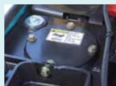
Réservoir d'huile hydraulique
