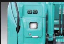
Un projecteur de travail à LED sur la tourelle
