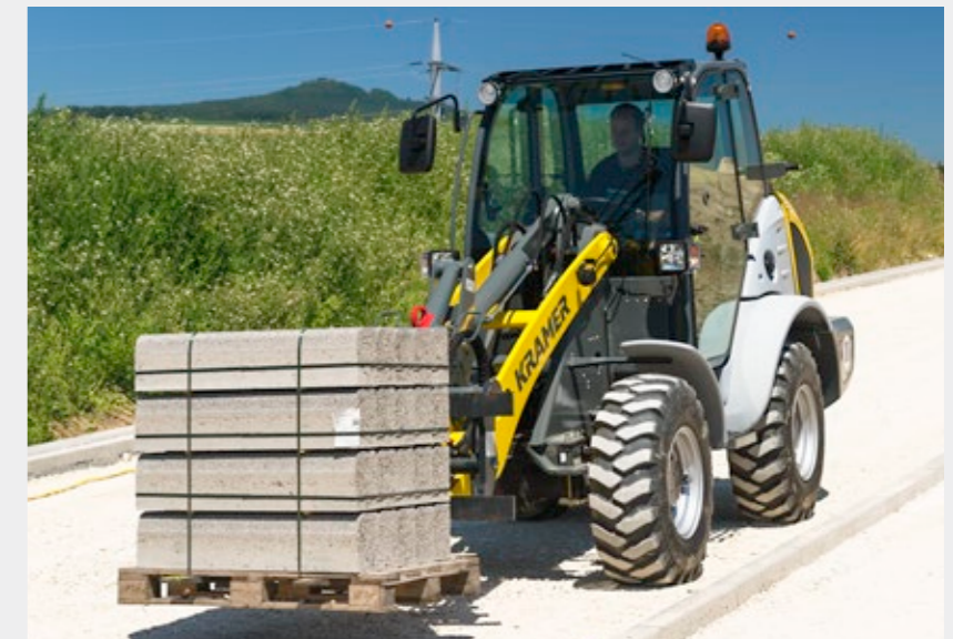
Direction essieu avant pour davantage de sécurité lors des déplacements de transport rapides
