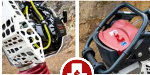
Pré filtre à air dans un boîtier autonettoyant qui maintient les coûts de maintenance bas
