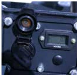
Démarrage électrique et horamètre pour une utilisation aisée
