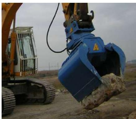
**2 Coquilles enrochement (ROC)** idéales pour la manipulation des cailloux et de la terre lors d'opérations d'enrochement...
