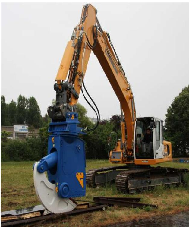
Les grugeuses Arden Equipment se montent sur des pelles de 28 à 50 tonnes.
